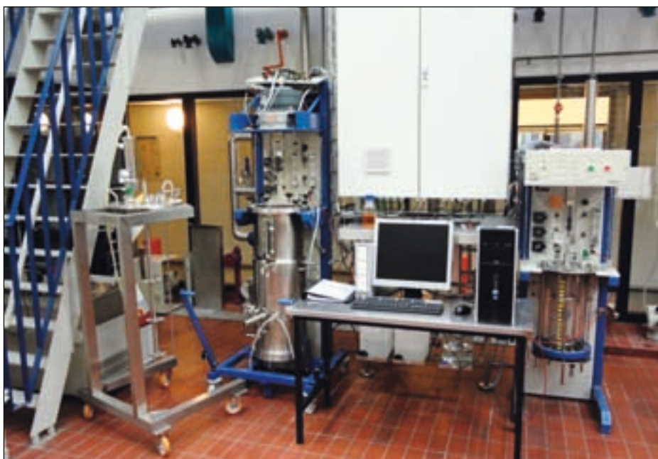
Figur 2. En 150 liter traditionel omrørt tankfermentor modtaget fra Novo Nordisk.
