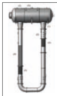
Figur 4. U-loop-fermentoren er 7 meter høj og rummer 150 liter.
